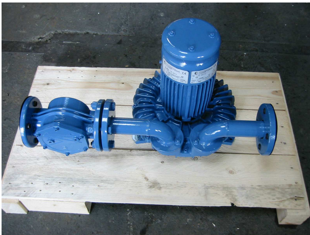
Foto 2: Typischer kleiner ATEX-Seitenkanalverdichter (Typ CL 10/01, z.B. 60 m 3 /h Luft bei 160 mbar) in Kompakt-Version mit Ansaugfilter (links).
